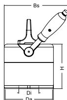
Cuando se transportan piezas de trabajo con diferentes dimensiones o propiedades, debe asegurarse de que se alcanza un factor de seguridad de 3.
