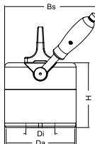
Beim Transport von Werkstücken mit anderen Abmessungen bzw. Eigenschaften ist darauf zu achten dass ein Sicherheitsfaktor von 3 erzielt wird. Ringe müssen eine mindestens eine Ringauflagebreite von 10 mm aufweisen, pro cm<sup>2</sup> Auflagefläche sind 3,5 kg Traglast anzunehmen, wobei die maximale Traglast nie überschritten werden darf.
