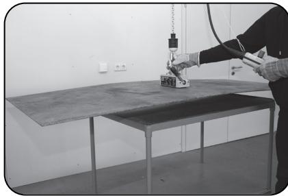
6. Soulevez la charge de quelques centimètres et vérifiez à certains Centimètres et vérifier que la charge est solidement tenue par l'aimant de levage
