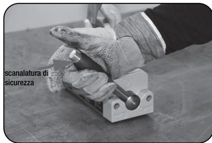
5. Verificare che il sollevatore magnetico sia completamente attivato. Come indicatore c'è un anello sulla leva il quale deve essere completamente visibile.
