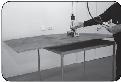
6. Heben Sie die Last um einige Zentimeter an und prüfen Sie, ob die Last vom Lasthebemagneten sicher gehalten wird
