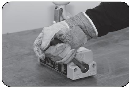
9. Débranchez l'aimant de levage en appuyant sur le bouton du levier de commande et en tournant celui-ci de gauche à droite
