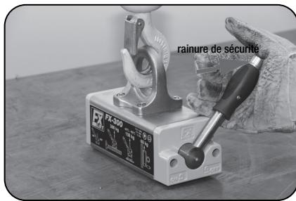
10. Assurez-vous au moment du débranchement que l'aimant de levage est complètement débranché (indicateur dans ce cas est à nouveau la rainure de sûreté qui doit à nouveau être complètement visible)
