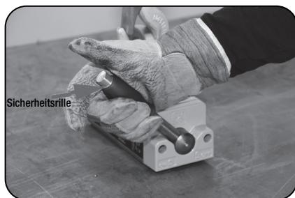
5. Stellen Sie sicher, dass der Lasthebemagnet komplett geschalten ist. Als Indikator hierfür gilt die Sicherheitsrille am Schalthebel, welche komplett sichtbar sein muss
