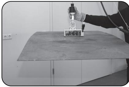
7. Effectuez l'opération de levage. Prenez note que le levier de commande de l'aimant de levage ne doit pas être utilisé comme poignée de guidage manuel
