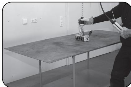
3. Setzen Sie den Lasthebemagneten auf dem (sauberen, ebenen) Werkstück wie gezeigt auf (Beachten Sie auch Abb.1)
