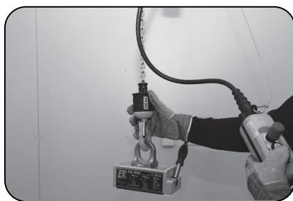
2. Fahren Sie mit dem Lasthebemagneten am Kran langsam auf das zu hebende Werkstück zu
