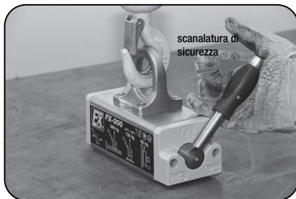
10. Una volta girata la leva verificare che il sollevatore magnetico sia completamente disattivato, (L'indicatore è sempre l'anello sulla leva il quale deve essere completamente visibile).
