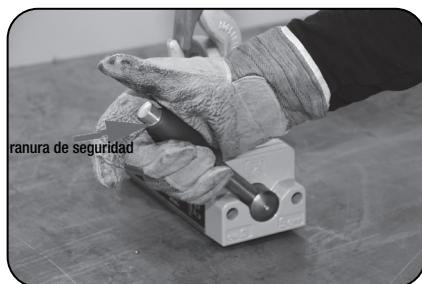
5. Asegúrese de que el imán está completamente activado. La ranura del maneta tiene que estar visible. Asegúrese de conocer
