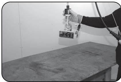
11. Retirez l'aimant de levage de la charge et stockez le à un endroit approprié.
