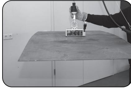
7. Iniziare l'operazione di sollevamento. La leva del sollevatore magnetico non deve essere utilizzata come guida per la movimentazione.
