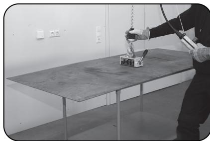
3. Posizionare il sollevatore magnetico sull'elemento (pulito e piano) come mostrato in Fig.1
