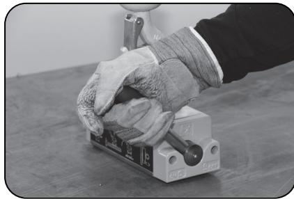
9. Schalten Sie den Lasthebemagneten aus, indem Sie den Knopf am Schalthebel drücken und (von links nach rechts) schalten
