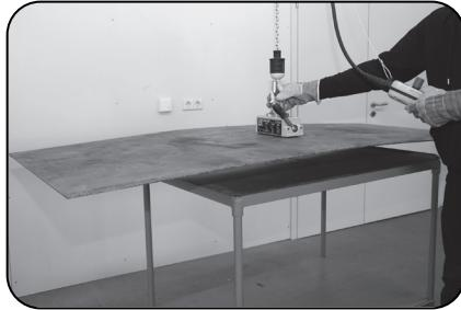
6. Sollevare il carico di alcuni centimetri e verificare che il carico sia tenuto in sicurezza dal sollevatore magnetico.
