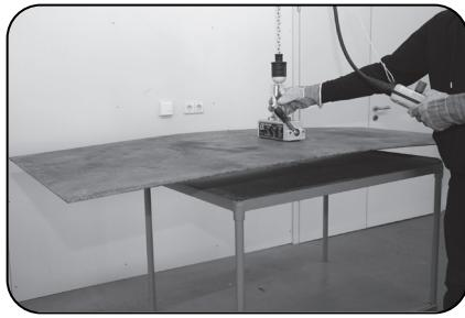
6. Levante la carga unos pocos centímetros y verificar que la carga está firmemente sujetada por el iman.
