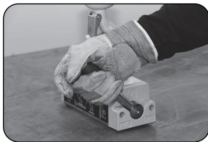
9. Una vez acabada la maniobra de elevación, pulse el botón de la palanca y movilice la palanca en sentido off. (sentido contrario)
