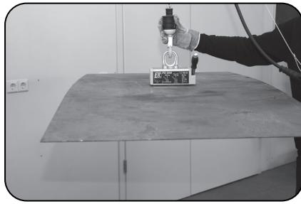
7. Führen Sie den Hebevorgang aus. Beachten Sie, dass der Schalthebel des Lasthebemagneten nicht als Handführungsgriff verwendet werden darf
