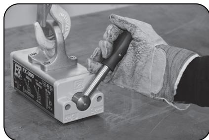
4. Attivare il sollevatore magnetico sopra il carico (da dx a sx)
