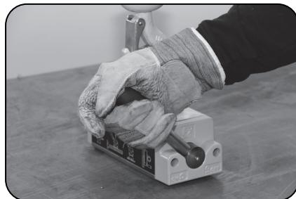
9. Disattivare il sollevatore magnetico spostando la parte mobile della leva e ruotandola nella posizione originaria (girarla da sx a dx)
