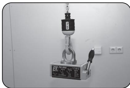
1. Fixez l'aimant de levage pour l'opération de levage à un palan afin que l'aimant est dans une position horizontale.
