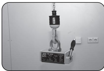
1. Hängen Sie den Lasthebemagneten an ein für den Hebevorgang geeignetes Hebezeug, so dass dieser waagerecht hängt
