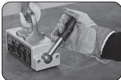
4. Schalten Sie den Lasthebemagneten auf dem Werkstück ein (von rechts nach links)
