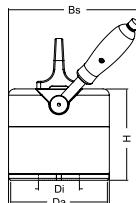
Lors du transport de pièces de différentes dimensions ou propriétés, il faut s'assurer qu'un facteur de sécurité de 3 est atteint. Les bagues doivent avoir une largeur minimale de 10 mm, une charge de 3,5 kg par  $\text{cm}^2$  de surface d'appui doit être assumée, la charge maximale ne devant jamais être dépassée.
