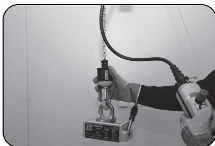
2. Avancez avec le palan et l'aimant de levage lentement vers la pièce à usiner.
