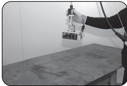
11. Entfernen Sie den Lasthebemagneten von der Last und bewahren Sie ihn an einem geeigneten Ort auf
