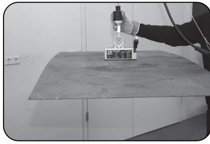
7. Realizar la operación de elevación completa. Tenga en cuenta que la palanca de los imanes no debe ser utilizado como asa manual de guía.
